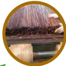
Verdichten der schmalen Bamboo X-treme® Streifen unter hohem Druck.
